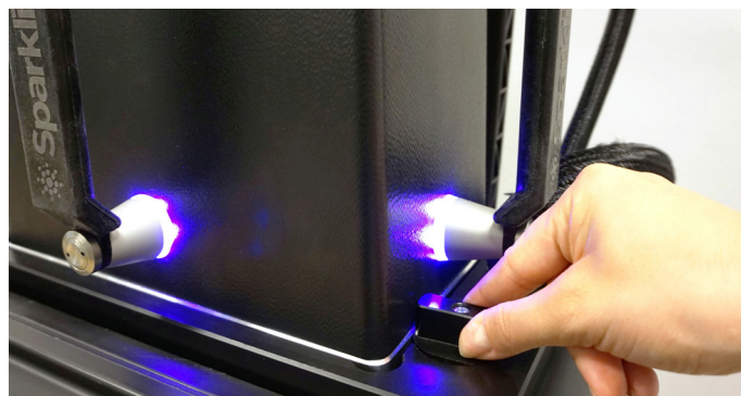
Zablokovanie gombíka a kontroliek LED na rukovätiach
