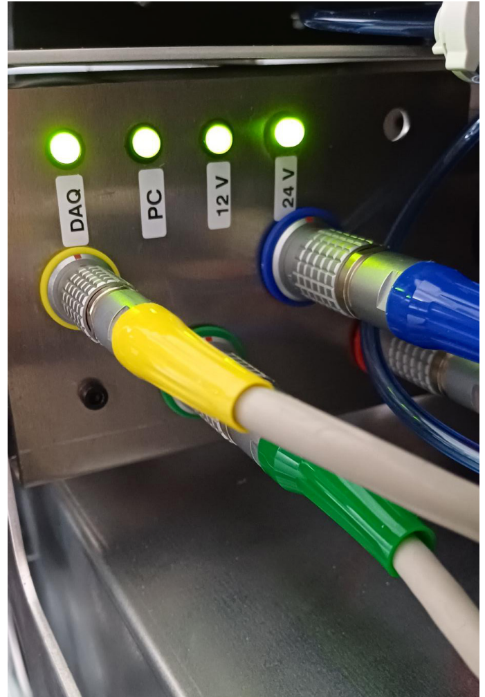
Panel konektorov, káblové pripojenia a indikátory LED vo vnútri puzdra
