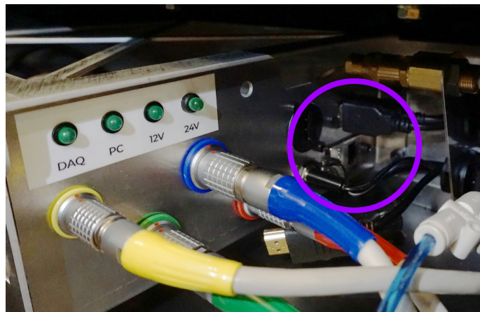
Umiestnenie ethernetového konektora v paneli konektorov vo vnútri vozíka
