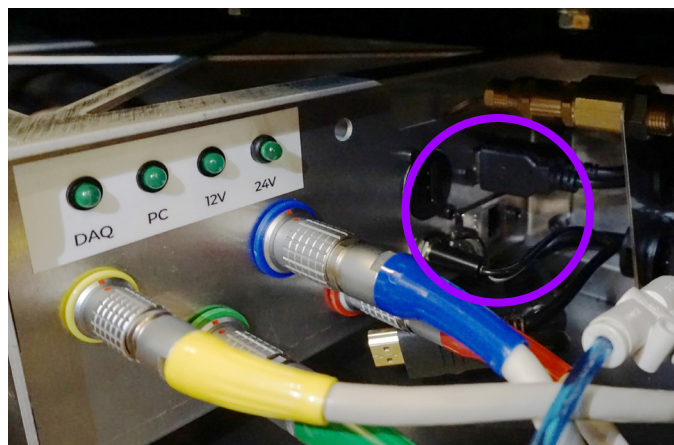
以太网连接器的位置,在主机箱内连接器面板上
