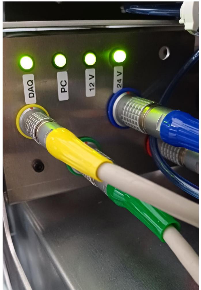
连接面板,数据线连接器和指示灯都在机箱内
