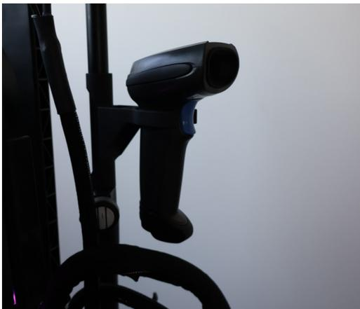
5. 将条形码读取器装在显示器支架上,并把条形码USB数据线与主机连接。
