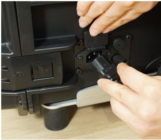
**7.** 将随机附带的电源线一端与主机连接,另一端与主供电电源插座连接。
