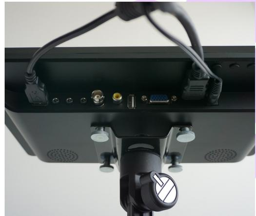
4. 连接HDMI, USB和电源线连接至显示器。
