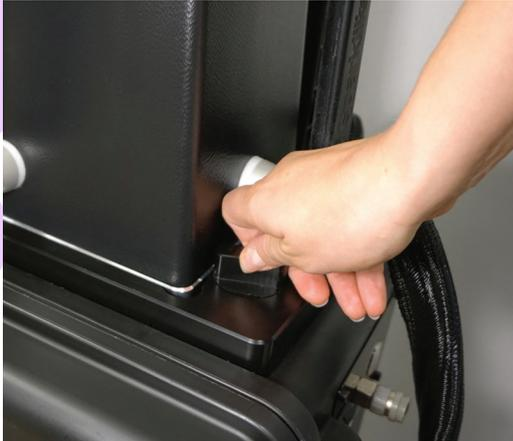
1. 将探测头放置在拉杆箱顶部的托座上。请记得用锁定按钮将探测头锁定到位。
