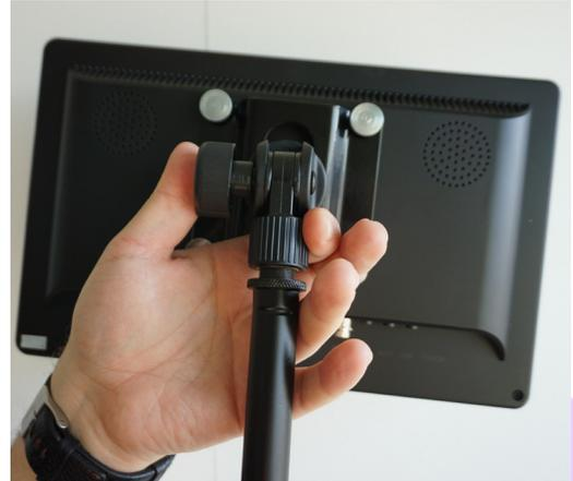
2. 将显示器与主机连接,并拧紧螺丝。
