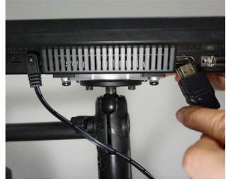
3. Conecte el cable HDMI y el cable de alimentación a la pantalla.
