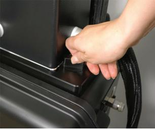
1. Coloque el cabezal de medición en su soporte sobre de la maleta. Recuerde utilizar la pestaña giratoria para bloquear el cabezal en dicha posición.
