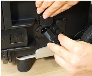
5. Conecte el cable de alimentación a la unidad principal y su otro extremo a una toma de corriente.
