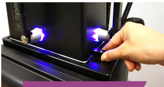
Uzamknutí kolíkem a indikační diody na rukojetích
