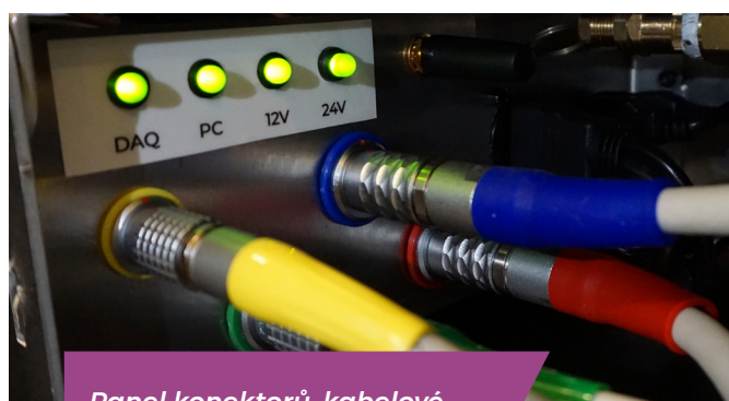
Panel konektorů, kabelové připojky a kontrolky uvnitř kufříku
